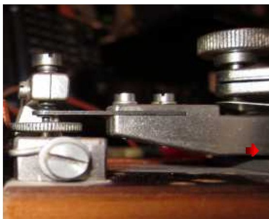
T.v. Övre och undre justerskruv. Uppe t.h.: Fjäderskruven
